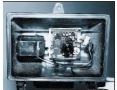
Bild 3: Kameramodul und Servoantrieb passen zusammen in ein handelsübliches Halogenstrahlergehäuse.
