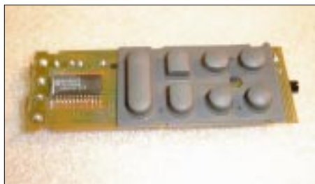
Bild 1: Läßt sich die Fernbedienung zerstörungsfrei öffnen, hat man gute Chancen, ausgefallenen Tasten wieder Leben einzuhauchen.
